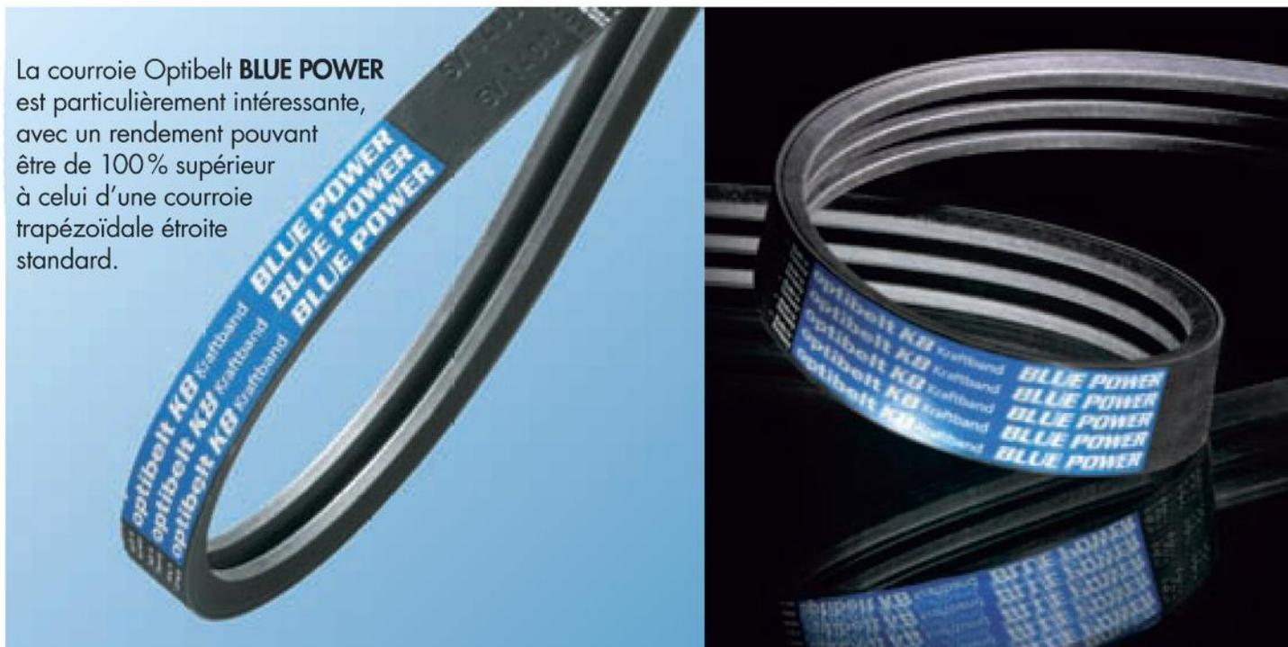
Cet évolution importante s'explique avant tout par l'utilisation de câblés aramides à faible allongement qui, en comparaison aux câbles en polyester, résistent beaucoup mieux à la traction et à la rupture. Le reste de la structure de la courroie Optibelt **BLUE POWER** a été adapté à cet excellent potentiel avec des matériaux de haute qualité. L'enveloppe textile résiste à l'usure et est d'autre part adaptée à l'utilisation de galets tendeurs.
